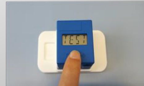
Cube-Reader aufgesetzt und messbereit
